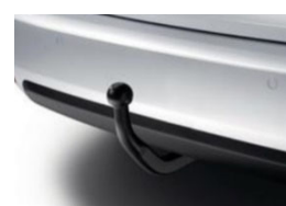
Szerszám nélkül leszerelhető vonóhorog 13 pólusú csatlakozóval
