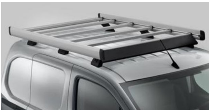
Alumínium tetőcsomagtartó L1 járműhosszhoz, 120kg teherbírás
